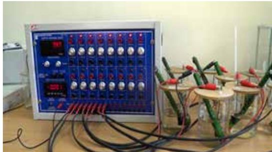
اختبار الحماية الكاثودية ضد التآكل
